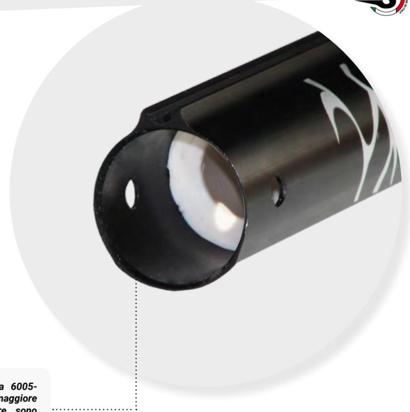
*Tubo Nemesis in alluminio lega 6005-T6, con guida asta per una maggiore precisione, nella parte inferiore sono presenti due nervature per aumentare la resistenza alla torsione del tubo. Diametro esterno 28, leggero ma molto resistente.*
